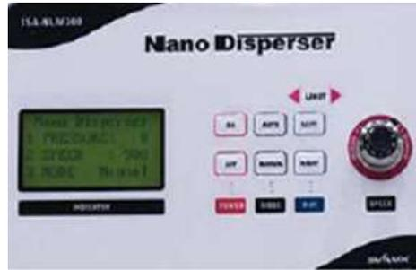
调节机动泵速度, 可以调整压力
