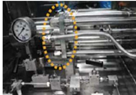
增压机部分安装冷却装置
